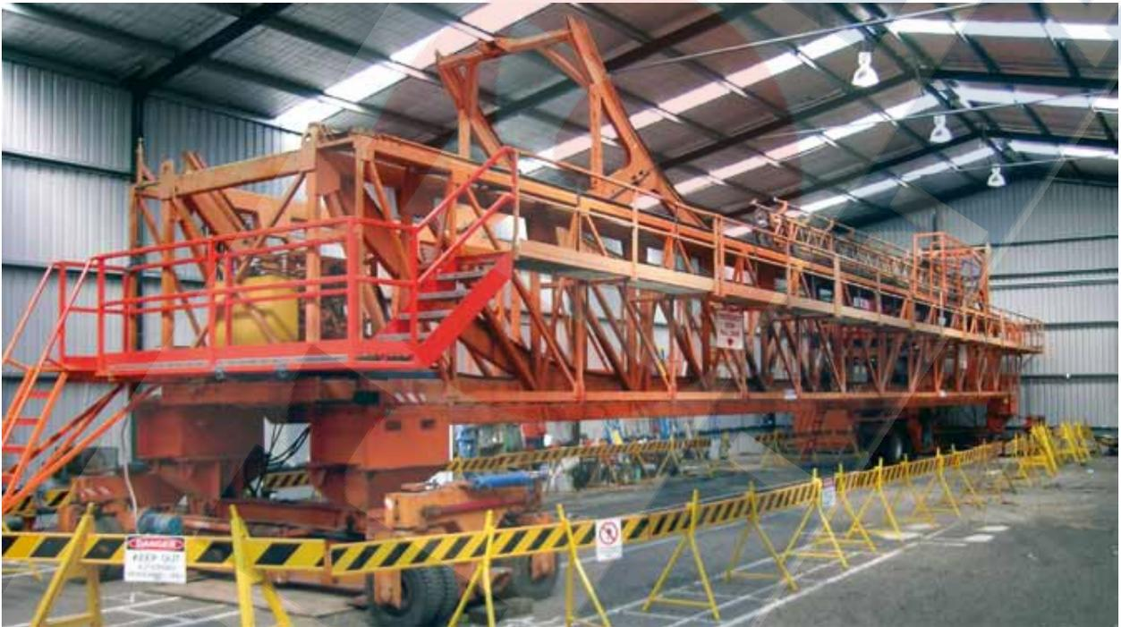
ALF可以在很短的时间内对路面进行测试和对它的使用情况进行评估并与正常交通量情况下的测试场地进行比较。
